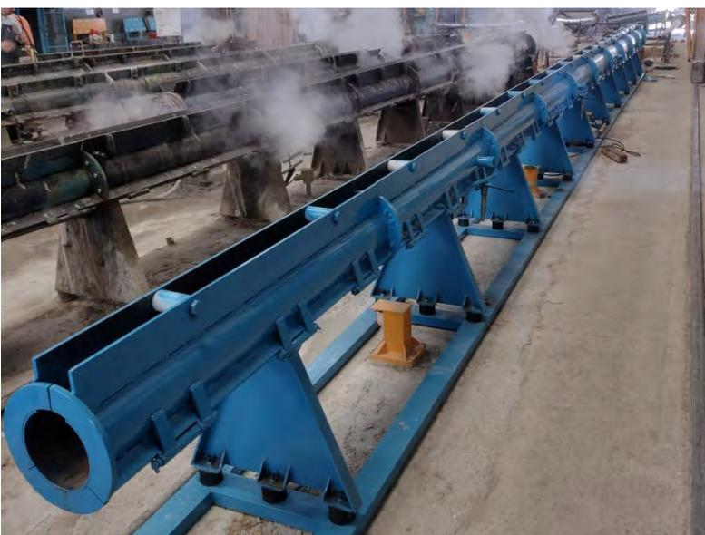
Nuestra fábrica de columnas y accesorios de hormigón para líneas eléctricas, Hormicoop, adquirió en el mes de marzo un nuevo molde de baja tensión, de 15 metros de longitud.
